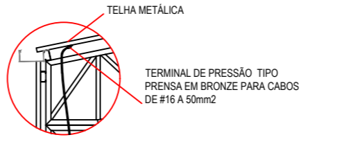
DETALHE - CONEXÃO DA DESCIDA C/ A TELHA METÁLICA S/IESC.
